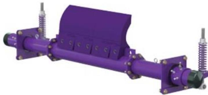
El Prelimpiador de trabajo extremo MXP es el prelimpiador más grande y más resistente que ofrece Flexco. Diseñado con una construcción de trabajo pesado completa, MXP cuenta con un eje central de gran tamaño de 8" (200 mm) y una altura de hoja de 19-3/8" (490 mm). Esto garantiza una limpieza óptima en las poleas más grandes y las bandas más anchas en las aplicaciones más difíciles que ofrece la industria de la minería.
